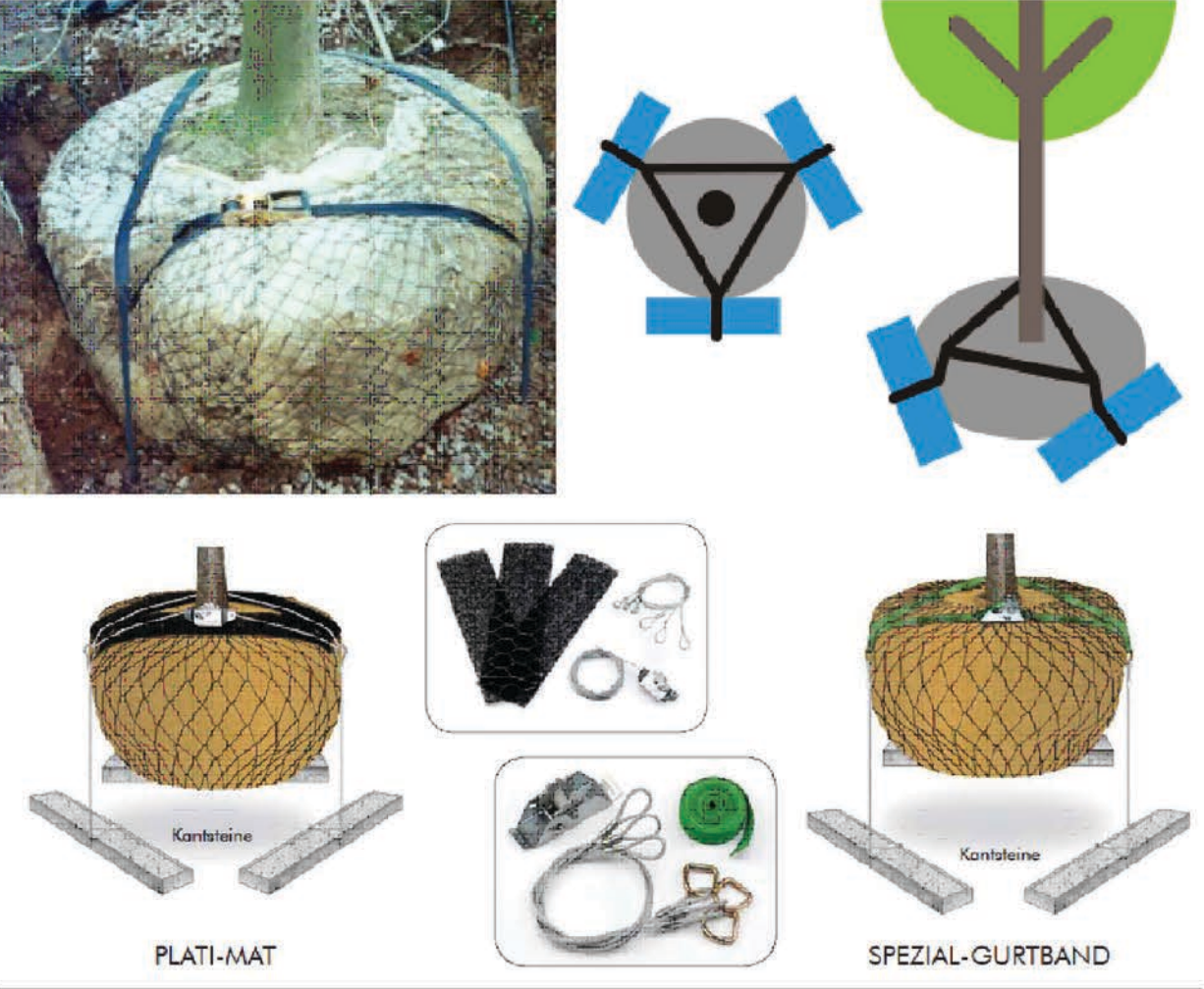
SCHEMATICKE ZNÁZORNENIE PRINCÍPU PODZEMNÉHO KOTVENIA ZA KOREŇOVÝ BAL
